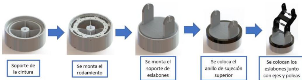
Fig. (8): Proceso de ensamblaje del manipulador.
