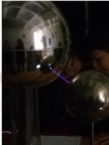
Figura 3. Arco eléctrico producido por la diferencia de cargas entre dos cuerpos
