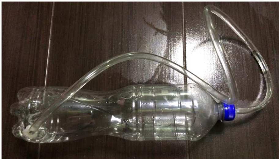
180 Figura 3. Equivalente hidráulico al circuito oscilador pasivo (LC)
